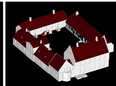
Herrgården Nørre Vosborg. T.v. 3D-uppmätning med totalstation. T.h. Digital uppmätning bearbetad till förmedling 2004. Frilandsmuseets ritkontor.
